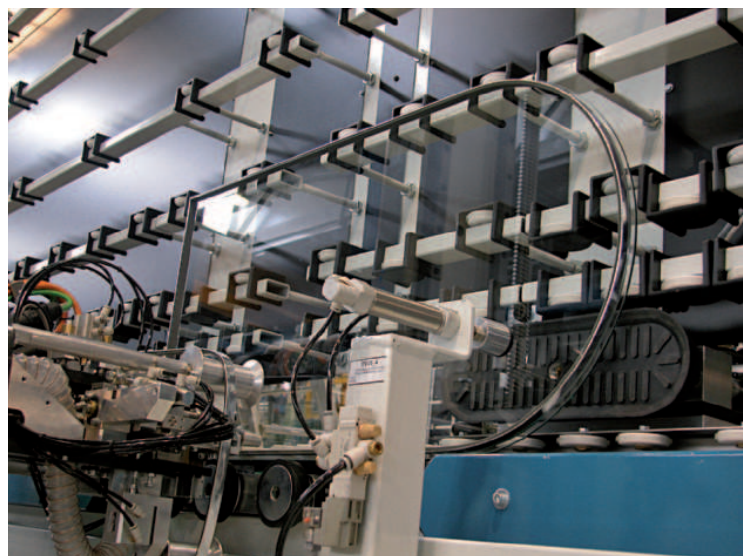
La produzione dei pannelli di vetro isolante è altamente automatizzata per rispondere all'esigenza di una produzione oraria/giornaliera elevata. Sono automatizzate tutte le fasi della lavorazione compresa l'applicazione automatica dei distanziatori (immagine cortesia For.El Spa)
