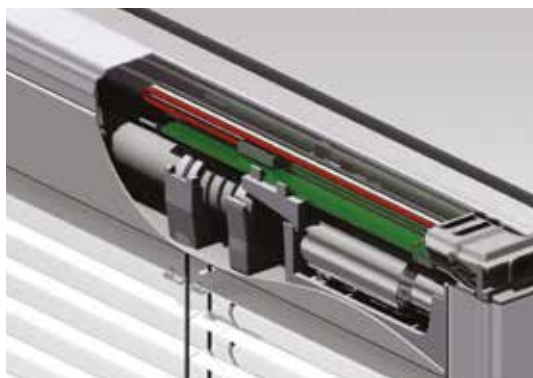
Motore interno Brushless interfacciabile con impianti domotici; certificato IFT per Life Test superiore a 216.000 cicli completi (standard VE 07/2)
